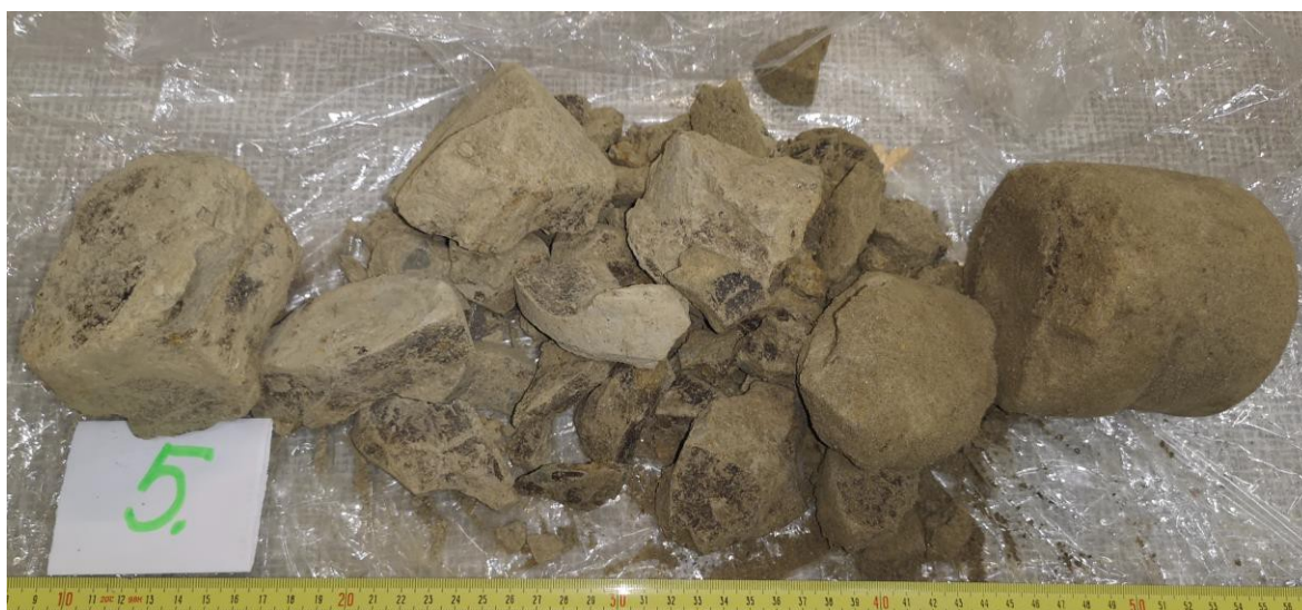
Próba nr 5: otwór nr 3, gł. pobrania próby 7,1m - 7,5m
