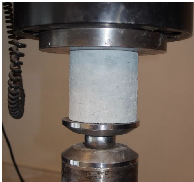
Rys. 2. Próbką w teście jednoosiowego ściskania
