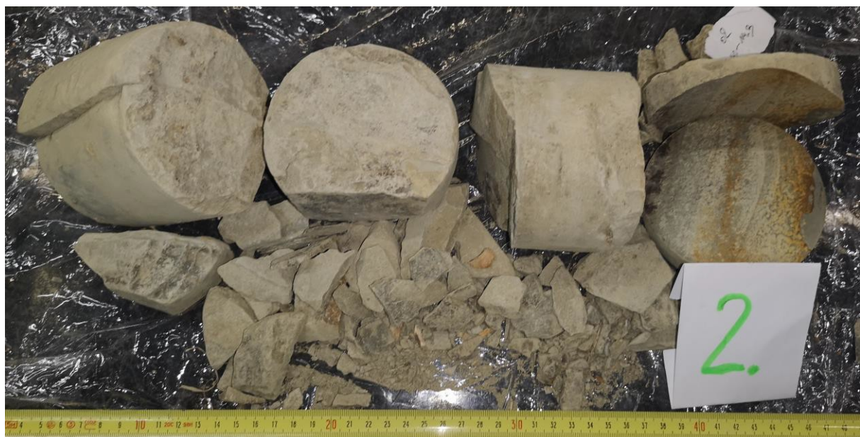
Próba nr 2: otwór nr 2, gł. pobrania próby 14,0m - 14,3m
